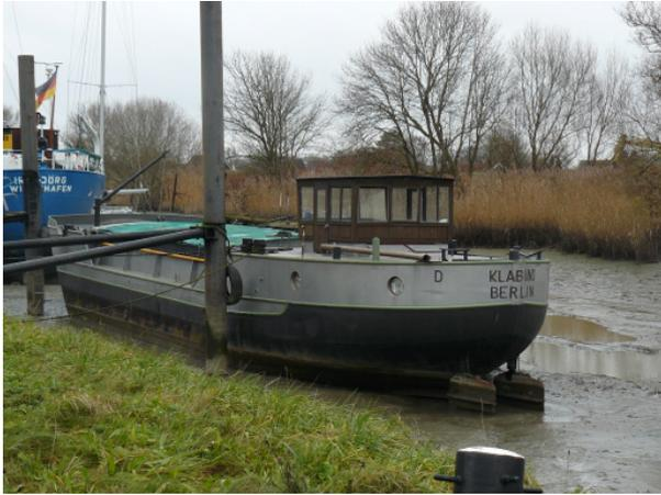
Binnenschiffsheck mit Doppelruder
